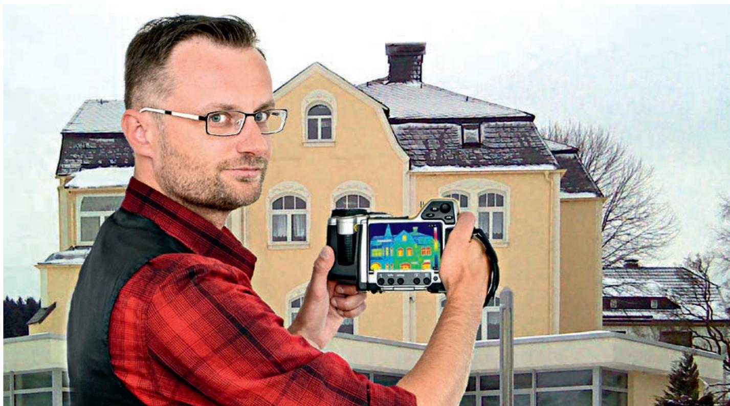
Thermografie- oder Wärmebild-Aufnahmen helfen Eigentümern dabei, die energetischen Schwachstellen einer Gebäudehülle aufzudecken und einen möglichen Sanierungsbedarf zu erfassen. Die Energieversorgung Marienberg GmbH bietet allen Hausbesitzern die Möglichkeit, eine Thermografie-Aufnahme (Wärmebilder) Ihres Gebäudes erstellen zu lassen.
